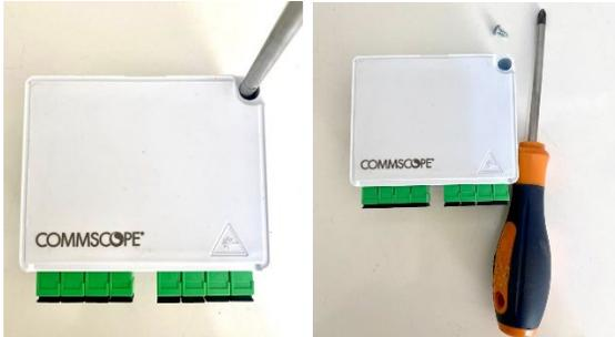
Precione a lateral da tampa, para abrir e ter acesso a parte interna dos adaptadores.
