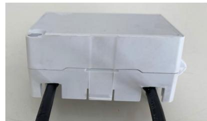
Após feita fusão da emenda de alimentação do splitter, fixe a caixa na parede usando bucha e parafusos, enviados no kit,
