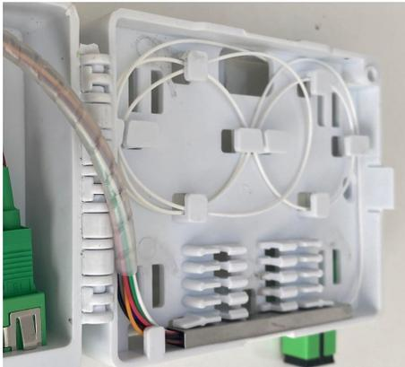
Em caso de emenda da fibras de alimentação dos splitters, corte o conector de alimentação do splitter e encaminhe a fibra para o compartimento das emendas
