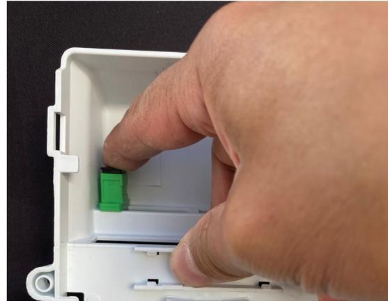
Encaixe os adaptadores de dentro para fora, seguindo o chaveamento, começando nas posições de baixo.
