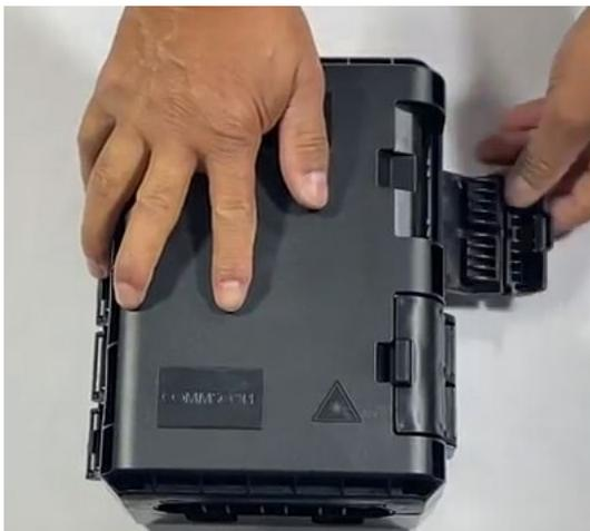
Retire o parafuso que prende a bandeja à caixa e destrave para abri-la lateralmente.
