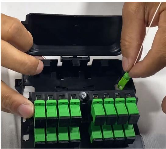
Plugue os primeiro conectores no painéis localizados na parte de baixo e depois nos de cima, deixando um sobra na parte de trás, abaixo da tampa.
