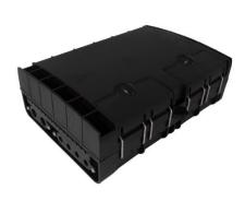
A caixa terminal óptica EMB-CTO16 da Commscope foi projetada especialmente para a utilização em redes FTTx visando facilitar e agilizar as instalações. É feita para acomodação de divisores ópticos e até 48 fusões. Possui 16 portas para cabo drop flat de 2x3 mm, duas portas para a entrada de cabos ópticos de 7 à 16 mm e quatro portas de derivação para cabos de 6 à 12 mm. É resistente à chuva e à corrosão salina e possui proteção UV, ideal para uso externo.
