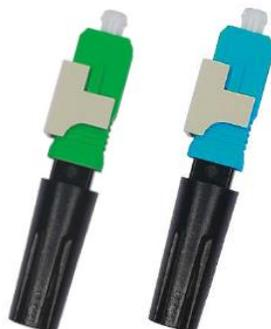
O Conector de campo modelo bipartido é um conector óptico reutilizável que foi desenvolvido para a conexão rápida e fácil em cabos drop flat (2x3mm). Está disponível na versão SC com polimento APC e UPC.
